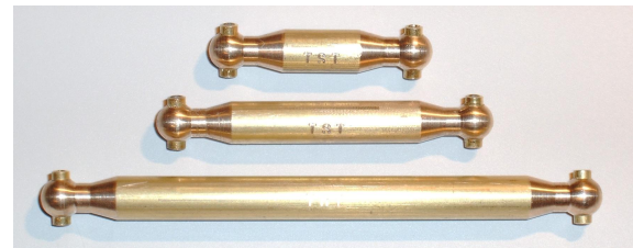
Abb. 1: Nachbau der Antriebswellen 31416, 31417 und 31418 aus Messing
