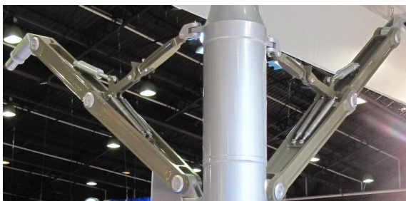
Abb. 6: „Knie im Knie“ beim A350. Man sieht, wer die größten Kräfte aushalten muss (Quelle: Wikipedia, Fotograf: Tangopaso).
